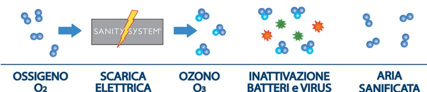
I generatori di ozono Sanity System sono dotati del "Sistema sicuro", che permette di riconvertire in brevissimo tempo, l'ozono residuo in ossigeno.
